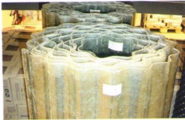
Plošče iz poliestrske smole, armirane s steklenimi vlakni.
